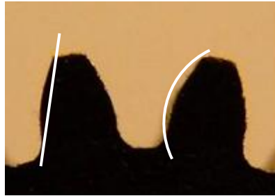
Figure 2 : Profil d'une dent, comparaison avec une droite et un arc de cercle
