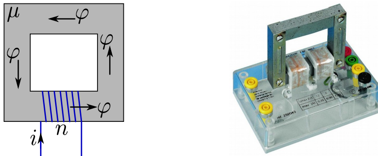
Figure 7: Solénoïde muni d'un anneau de ferrite canalisant le champ magnétique.
