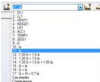
Sélectionner la charge *Ip* dans le menu déroulant **Cas de charge**
