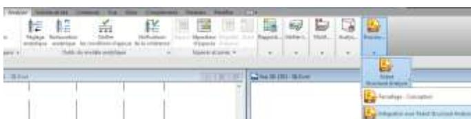
Dans l'onglet **Analyser**, sélectionner le menu déroulant **Structure** puis le menu déroulant **Robot Structural Analysis** puis **Intégration avec Robot Structural Analysis**
