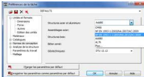
Pour Structures acier et aluminium, sélectionner : **NF EN 1993-1:2005/NA:2007/AC:2009**
