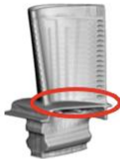
Figure 5 : Une aube de turbine haute pression (image G.L. Kindlmann) et la zone où survient la plasticité.
