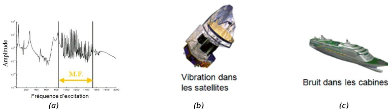
Figure 2 : Les vibrations moyennes fréquences des structures industrielles : (a) fonction de réponse en fréquence typique, (b) phénomènes observés.
