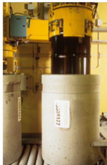
Conditionnement de déchets de faible activité en conteneur CBF-C.
