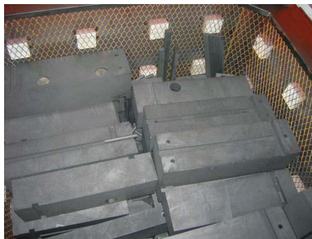
Déchets graphite de faible activité conditionnés en caisson métallique 7C de 5m 3 (Réacteur universitaire de Strasbourg).
