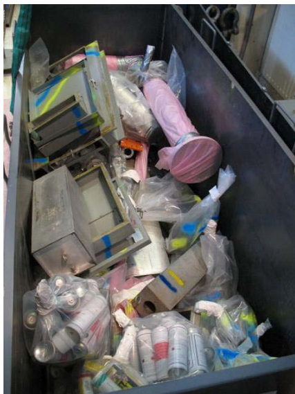
Déchets TFA conditionnés en caisson tôle (Réacteur universitaire de Strasbourg).
