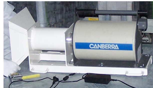
Exemple de chaîne de spectrométrie gamma portable, équipée d'un collimateur permettant des mesures de 4 m 2 de surface.
