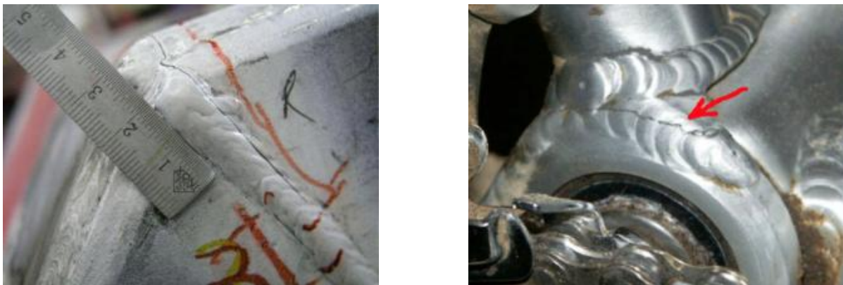
Figure 1 : Exemples de fissures sur aluminium [2]
