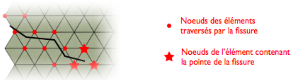
Figure 5 : La méthode X-FEM : maillage non conforme et nœuds enrichis.
