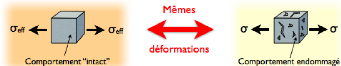
Figure 8 : Le principe d'équivalence en déformations.
