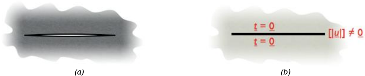
Figure 1 : Une fissure (a) et sa modélisation (b).
