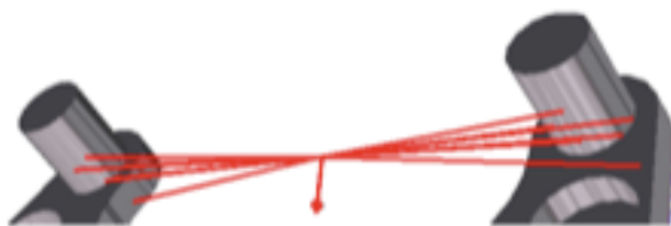
Figure 11 : Un élément rigide liant un ensemble de nœuds, et un glisseur exercé sur cet élément rigide.
