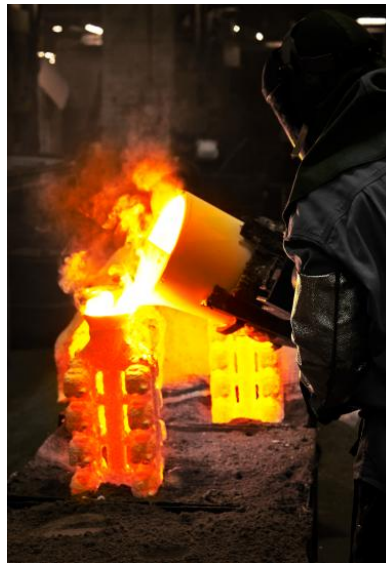
Figure 9 : Coulée manuelle en carapace
