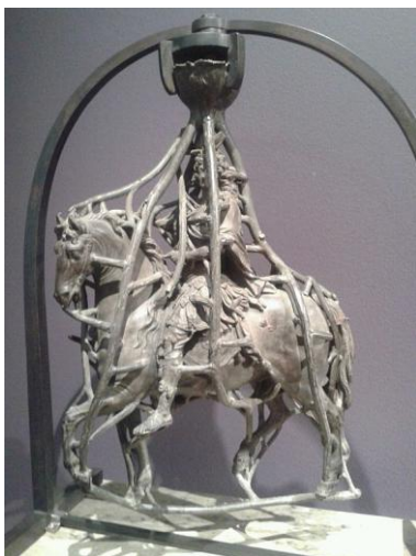
Figure 1 : Exemple d'une sculpture brute issue de la technique du moulage à cire perdue
