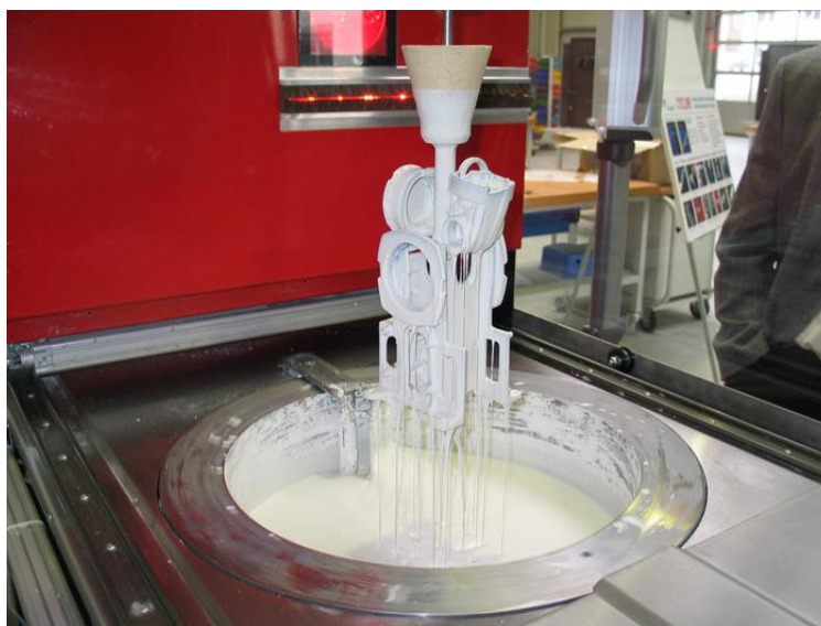
Figure 13 : Enrobage automatique d'une grappe de modèles Image MK Technology GMBH [6]
