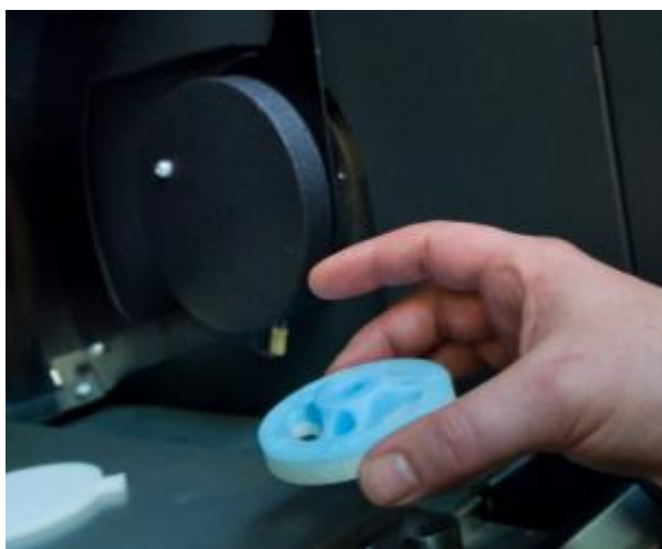
Figure 11 : Modèle en cire (bleu) et ses supports (blancs) fabriqué par projection de gouttes
