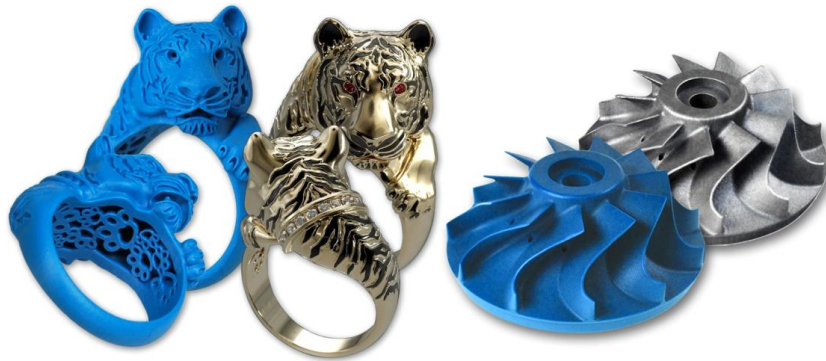
Figure 3 : Exemples de modèles et des pièces correspondantes, Images Multistation [3]
