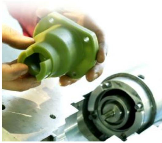
Figure 12 : Modèle injecté dans un moule métallique
