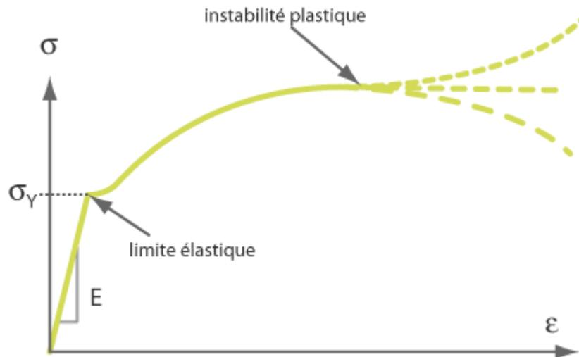
Figure 1 : Allure générale d'une courbe de traction pour un acier
