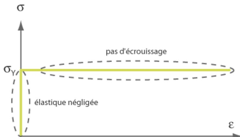
Figure 2 : Courbe de traction pour un matériau dont la partie élastique est négligée et ne possédant pas d'écrouissage
