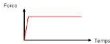
Figure 9 : Consigne de pilotage de l'essai de fluage
