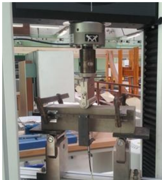
Figure 11 : Dispositif expérimental des essais de flexion 3 points
