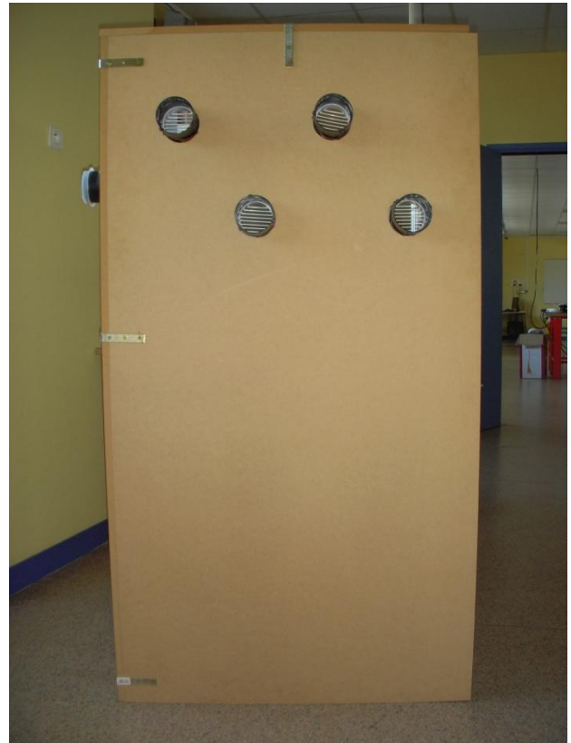
Vue arrière coté bouches insufflation VMC DF
