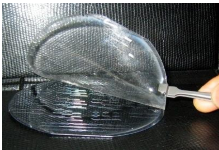
Figure 18 : Exemple de démoulage
