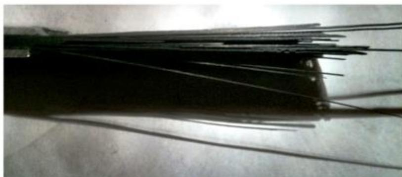
Figure 4 : Eprouvette unidirectionnelle après rupture : on observe de nombreuses fibres rompues.
