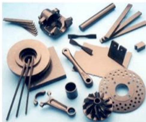
Figure 9 : Exemples d'applications des composites à matrice métallique. Image [4].
