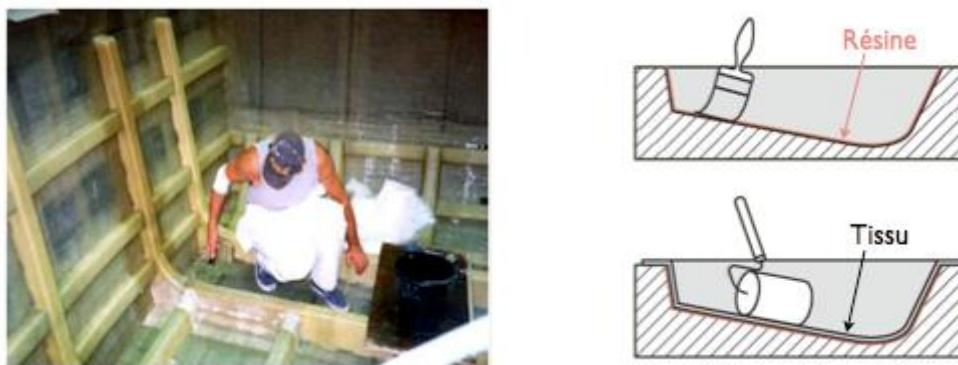
Figure 6 : Le moulage au contact (schéma Richard Geoffrion [3]).
