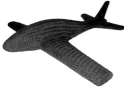
Figure 4 : Un modèle réduit d'avion en tissu de carbone 3D, réalisé pour tester un procédé de fabrication de préformes (image de l'Université nationale du design et des technologies de Moscou).
