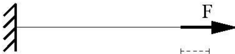
Figure 3 : Une barre en traction dont la rigidité est incertaine
