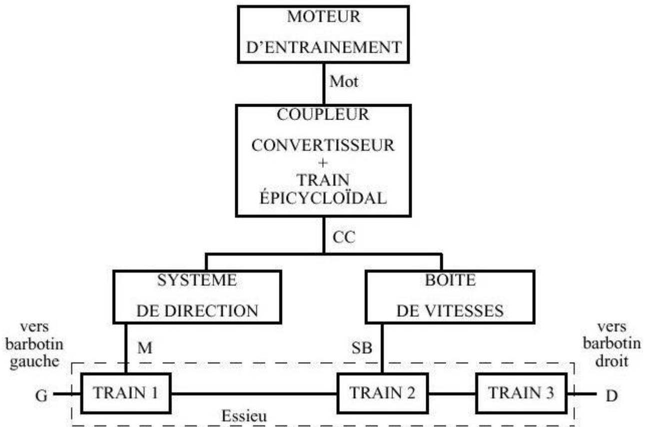
Figure 2 : Schéma de la transmission du D11R
