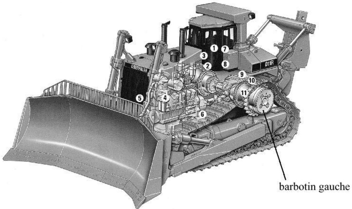
Figure 1 : Vue d'ensemble de la transmission du D11R
