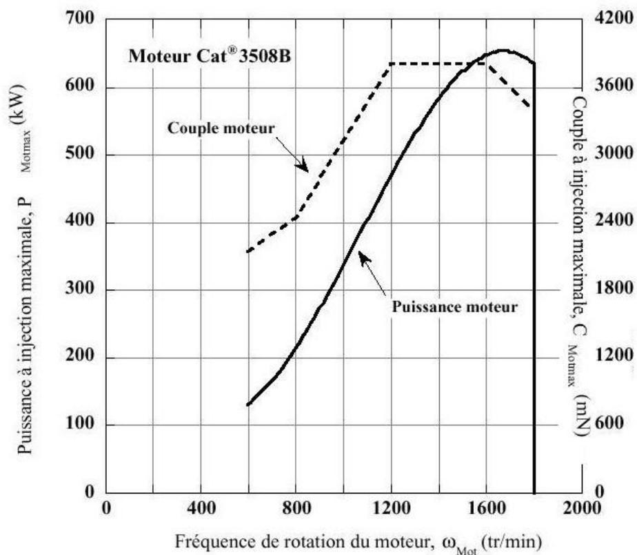
Figure 2 : Courbes caractéristiques du moteur.
