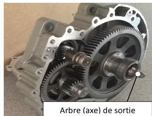
Tracer un repère sur l'arbre d'entrée et de sortie, puis mettre en rotation l'arbre d'entrée. Compter le nombre de tours à effectuer sur l'arbre d'entrée pour 1 tour de l'arbre de sortie.
