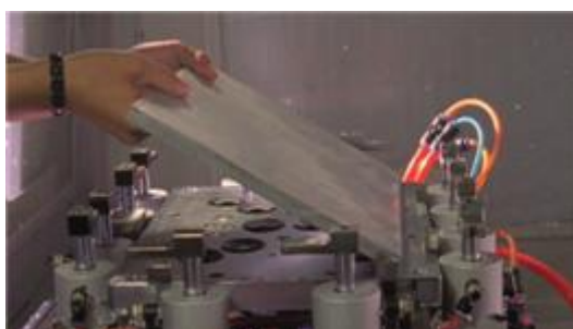
Figure 5 : Mise en position du brut sur le montage d'usinage
