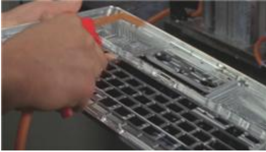
Figure 7 : Nettoyage à l'air comprimé
