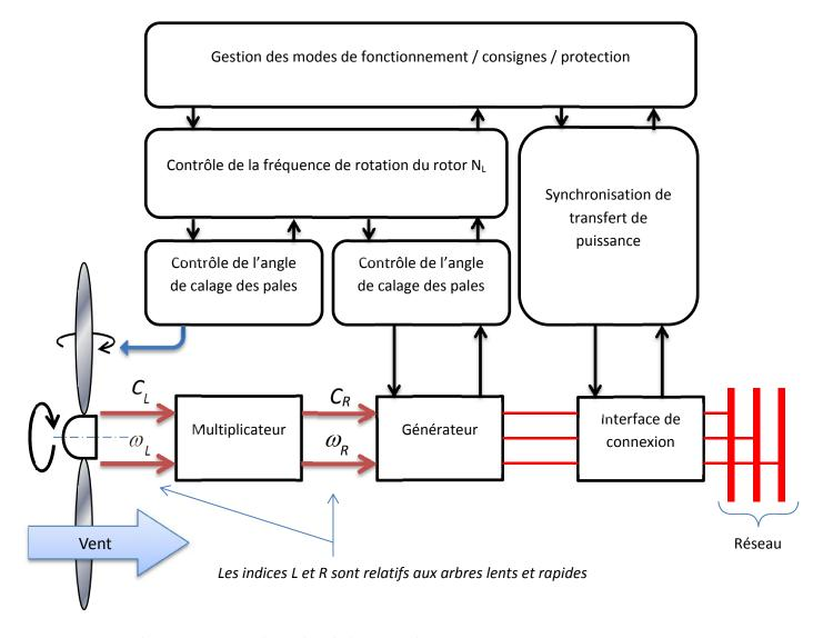
Les conditions de fonctionnement d'un aérogénérateur dépendent essentiellement des conditions de vent sur lesquelles aucune action n'est possible. La courbe de puissance donnée par le constructeur optimise la plage d'exploitation de l'éolienne en fonction de puissance nette transmise au réseau. On définit ainsi :
