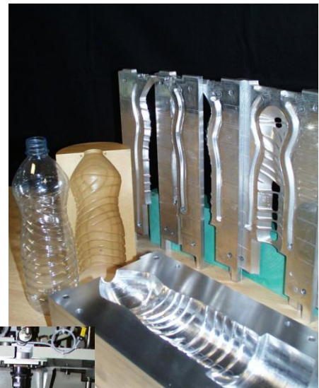
Outillage de soufflage réalisé en stratoconception.
