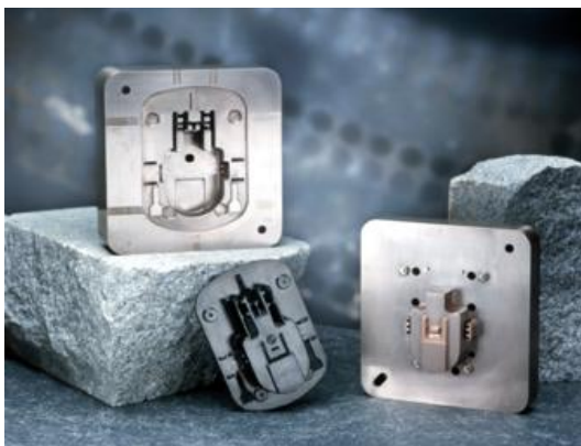
Outillage d'injection plastique obtenu en frittage de poudre métallique.
