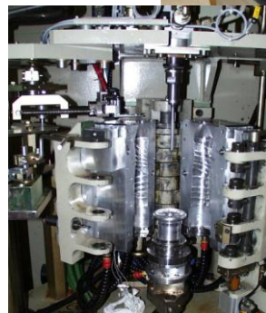
Outillage de soufflage réalisé en stratoconception.
