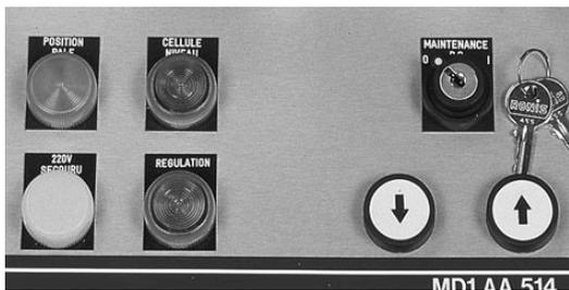
■ Pour commander l'ouverture du couvercle, il faut au préalable que la commande en soit possible : la pale doit être positionnée à l'arrêt vers la gauche (vue face aux commandes) et le voyant POSITION PALE est alors allumé.
