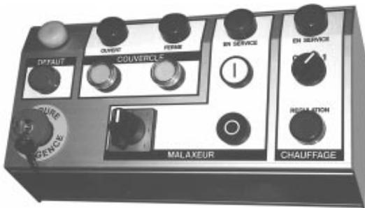
Ce coffret est destiné à se situer dans une salle de contrôle distante de la partie à commander. Pour une meilleure qualité des manipulations, il est préférable de fixer la boîte à bouton soit sur un châssis, soit sur une table. Par contre si vous possédez l'option automate programmable, fixer celui-ci sur le châssis aluminium suivant la procédure décrite page 12.
