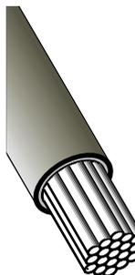
Le coeur de la fibre est en silice. Pour avoir le maximum de souplesse, chaque fibre est constituée d'une multitude de fibres unitaires d'un diamètre de 50  $\mu$  environ. Elles sont associées à des amplificateurs émettant dans l'infrarouge ou le rouge.
