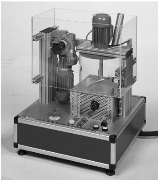
C'est un modèle de malaxeur industriel à échelle réduite. Les éléments fonctionnels sont intégrés par des profilés aluminium et protections plastique, avec pieds réglables pour mise à niveau.
