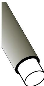
Le coeur de la fibre est en plastique souple (PMMA). Il n'y a généralement qu'une fibre de diamètre 0,25 à 1 mm suivant les modèles.
