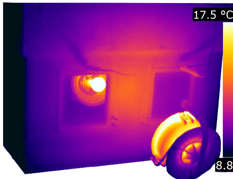
Figure 8 : Thermogramme de la maquette avec simulation du rayonnement solaire
