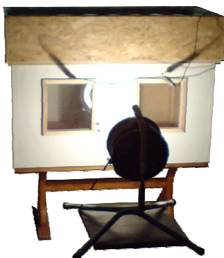
Figure 7 : Simulation du rayonnement solaire par une lampe de chantier
