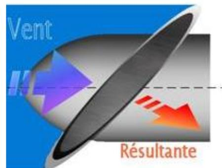
La pale crée une résultante à la force du vent, cette résultante est perpendiculaire à la pale avec le même sens que la force du vent, c'est elle qui permet le mouvement de rotation du rotor.
