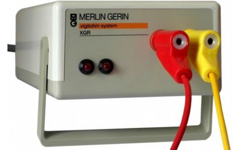
■ **Fonction** : génère une **tension spécifique** (alternative en créneaux de 100 V) pour produire un courant qui sera détecté par un récepteur mobile en vue de **localiser un 1<sup>er</sup> défaut d'isolement** dans une installation en **schéma IT**, sans empêcher son fonctionnement normal.
