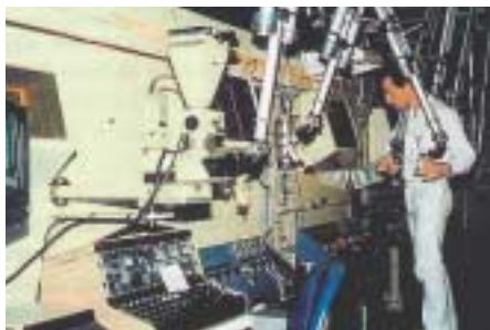
Télemanipulation de substances radioactives dans un laboratoire.
