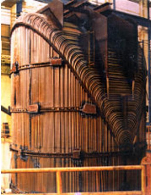
Figure: Tubes usagés d'un GV
