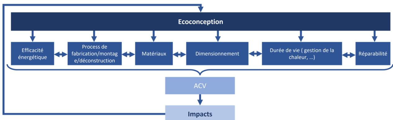
Figure 6 : Principe de l'écoconception des systèmes électriques.
