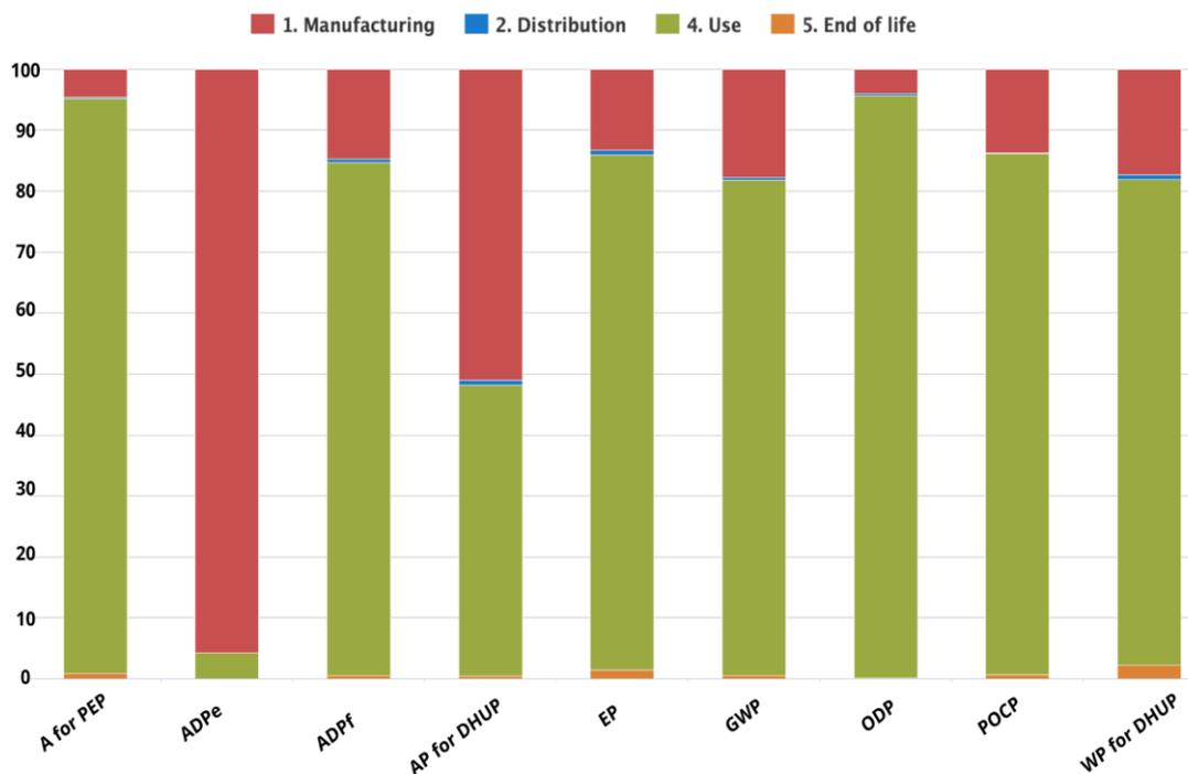
Figure 5-a : Bargraphe de l'alimentation linéaire pour 24V-5A en sortie (scénario 1)
