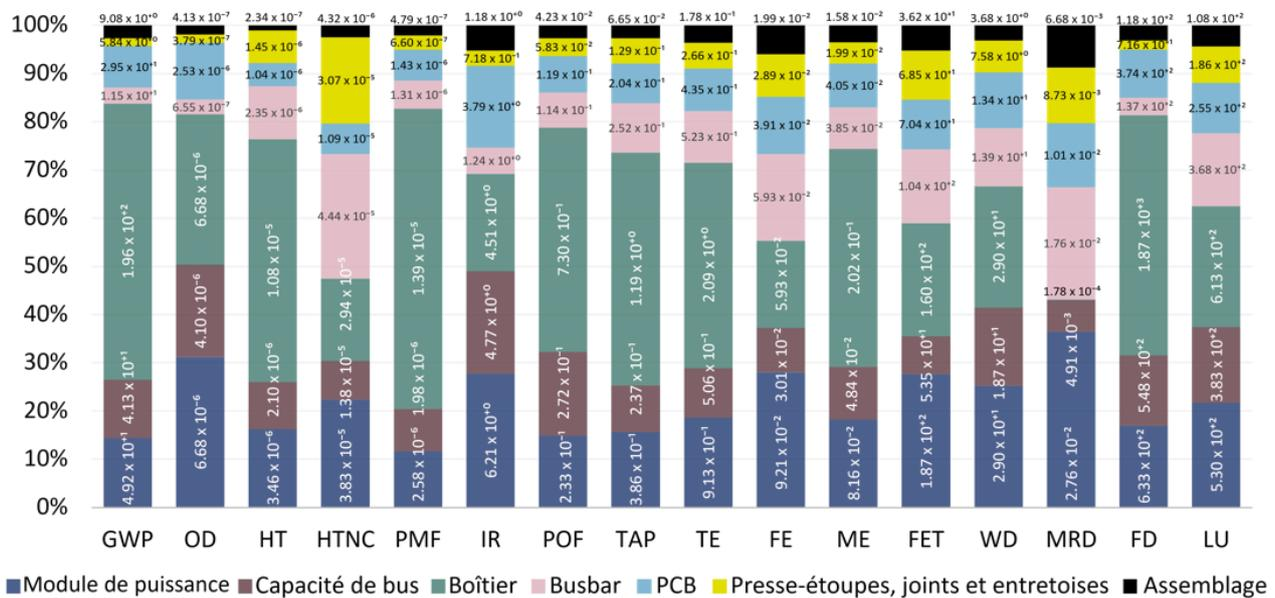
Figure 10 : Impacts environnementaux liés à la fabrication de l'onduleur de 150 kW.
