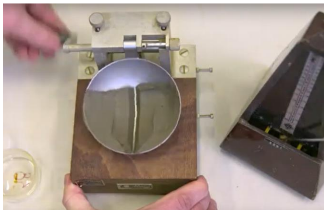
Figure 5 : Essai de limite de liquidité à l'aide de la coupelle de Casagrande, image extraite de la vidéo « Limites d'Atterberg »
