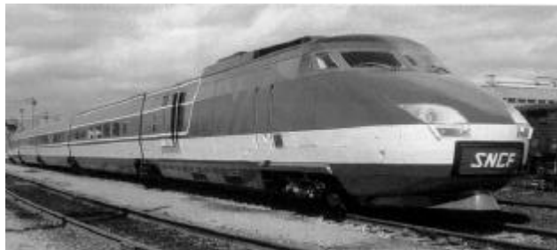
Figure 143 Premier "TGV", la rame TGV 001 à turbines à gaz. Cette rame de 4400 kW, à 4 turbines à gaz, avait 12 moteurs de traction à courant continu, autoventilés, de 360 kW. Elle pouvait rouler à 300 km/h ; ses 8000 l de carburant lui donnaient 1100 km d'autonomie à grande vitesse.
