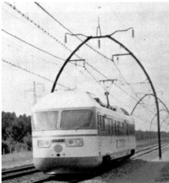
Figure 145 L'automotrice expérimentale Z 7001 en circulation d'essais à 300 km/h sur la ligne des Landes.
