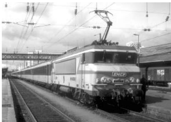
**Figure 132** La locomotive bi-courant à hacheur BB 22317 de 4400 kW sous caténaire monophasée 25 kV.
