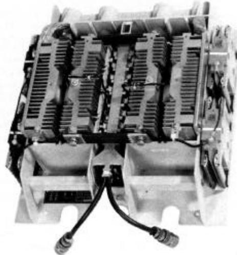
Tiroir "standard" de 2 thyristors de 3" équipant le hacheur de traction des éléments "MI79" de la SNCF et de la RATP circulant, en particulier, sur la ligne B du RER Ile de France.
