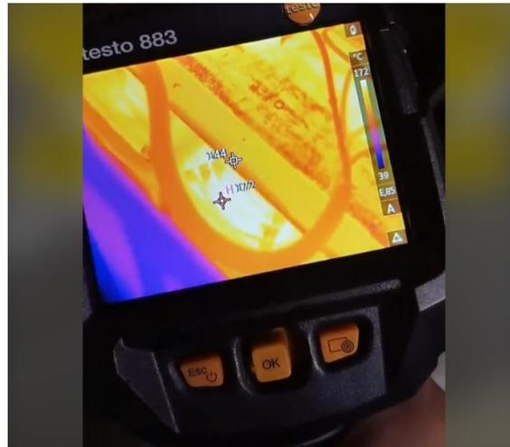
Nous avons un thermogramme de l'intérieur des enroulements du transformateur triphasé.
