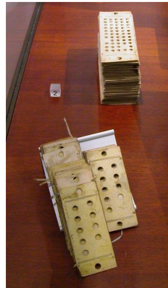
Figure 8 : Cartes pour la machine analytique de Charles Babbage (Musée des sciences, Londres), source [26]
