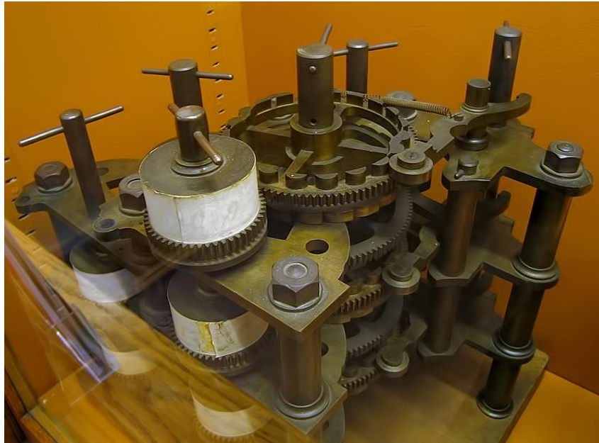
Figure 6 : Une partie de la machine à différences, pièces produites du temps de Charles Babbage et assemblées par la suite par son fils Henry, source [23]
