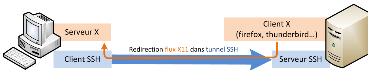
FIGURE 3 – Schéma d'une redirection X11 via SSH
