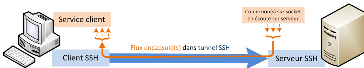
FIGURE 2 – Schéma d'une redirection sur le serveur SSH
