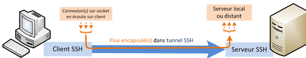
FIGURE 1 – Schéma d'une redirection sur le client SSH
