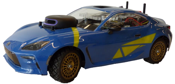
Figure 9 : Voiture autonome CoVAPSY_RPIonly avec sa carrosserie
