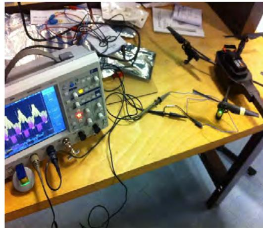
Figure 19 : Mesure des courants/tension du moteur
