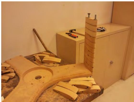
Figure 15 : récupération des bouts de pales, montage de la turbine, ponçage et finitions.
