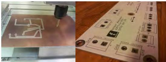
Figure 28 : fabrication des cartes électroniques (gravure anglaise à gauche / sous-traitance *Fritzing* à droite)
