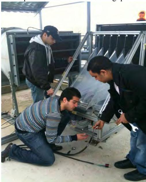
Figure 6 : installation de l'« ondulienne » sur le support d'essai de la soufflerie de l'IUT de Cherbourg-Manche
