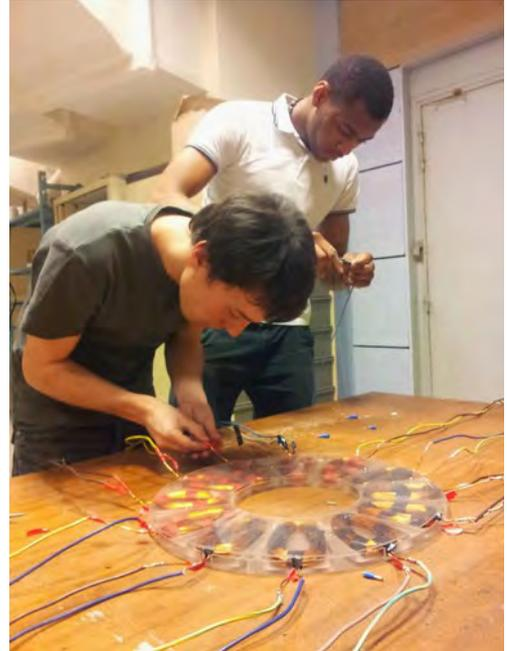
Figure 26 : deux étudiants réalisent les connexions des 12 bobines vers le bornier de sortie au *GIM'Lab*
