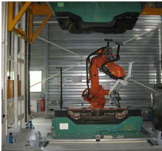
Figure 5 : projection de fibres de verre sur une préforme
