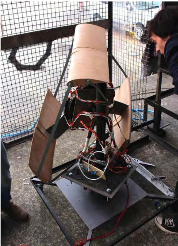
**Figure 36** : rupture de la soudure du support de génératrice de la Dionysienne 1, lors de la manche 2 (GIM'Eole 2014)
