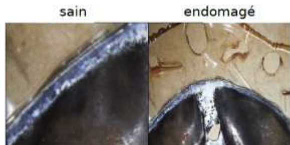
Figure 16. Photographie d'une membrane avec des "pinholes" à un stade avancé [26]
