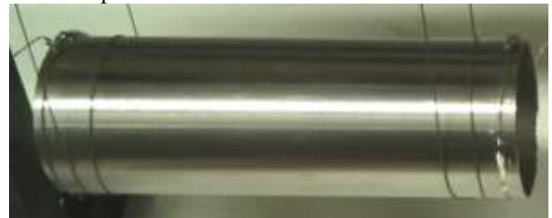
Fig. 7: l'échantillon sur le tube de 50 mm pour la mesure du courant de fuite
