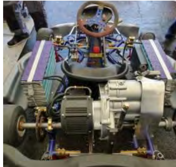
Figure 4 : Moteur ME1304 8.5kW(72V) PMSM Brushless refroidit à l'eau avec adaptation d'un boîtier de vitesse
