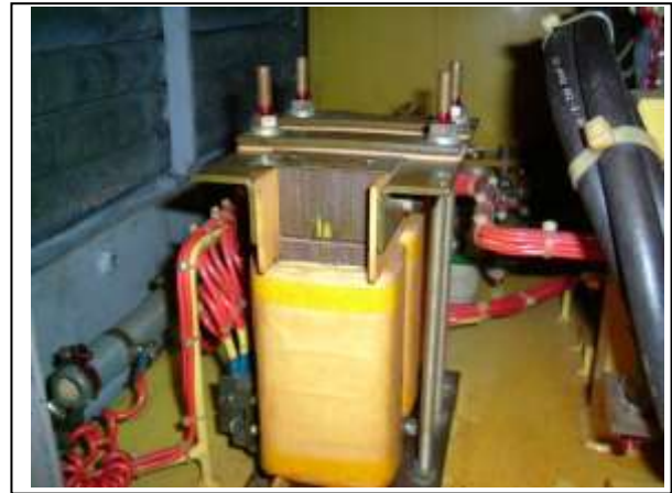
Figure 6 : Inductance à entrefer variable
