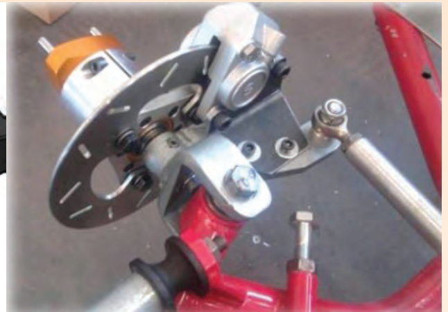
Etude et réalisation de frein flottant sur les roues avant
