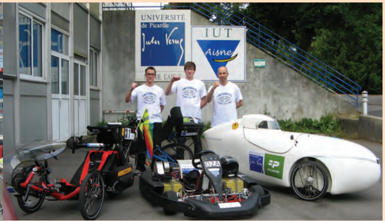
Différentes réalisations de véhicules électriques de gauche à droite : vélo couché, tricycle, karting vélo mobile.
