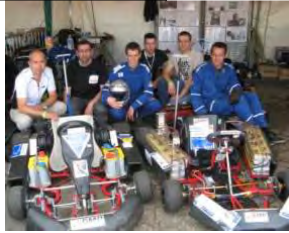
Figure 6 : Karts électriques 2 moteurs 28 kW nominal : 48V au plomb à gauche et Li-fer à droite 72V. Challenge National Vierzon e-Kart 2011.
