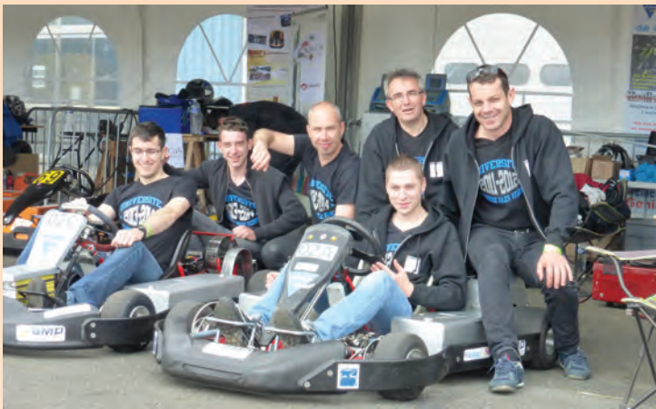
Karts électriques 2 moteurs 28 kw nominal: 48V au plomb à gauche et Li-fer à droite 72V. Challenge National Vierzon e-Kart 2011.
