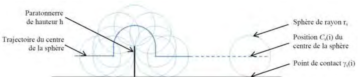
Figure 9 : Application de la méthode de la sphère roulante (Rayon r_s ) à une pointe de hauteur h
