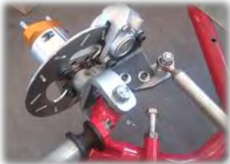
Figure 9 : Etude et réalisation de frein flottant sur les roues avant
