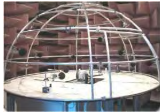
Figure 5 : Banc de test de l'alternateur dans une chambre semi-anechoïque
