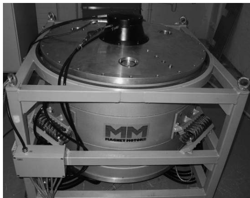
Figure 3 : Volant d'inertie utilisé comme source de puissance du convertisseur (MDS : Magneto-Dynamic-Storage)
