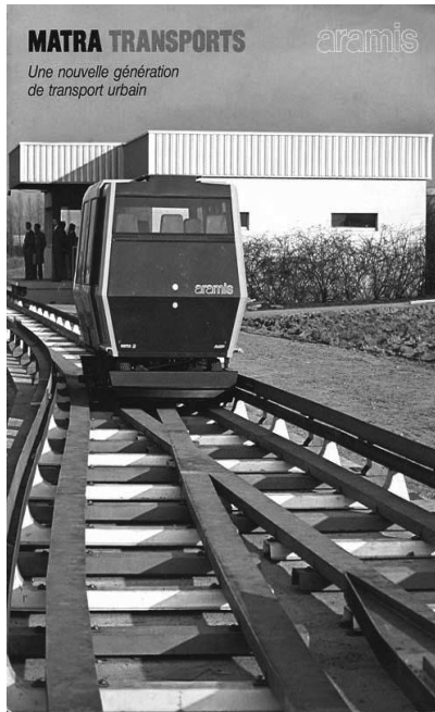
Fig.7- Document Matra Transport sur le projet de rames automatisées à wagons indépendants ARAMIS 1 .
