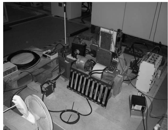
Figure 7 : Montage expérimental avec une charge résistive. On a utilisé des résistances tubes de charbon en série avec des résistances disques de charbon.
