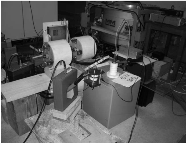
Figure 5 : Montage expérimental avec un condensateur de puissance au premier plan, au milieu le convertisseur et, à l'arrière plan, le générateur MDS
