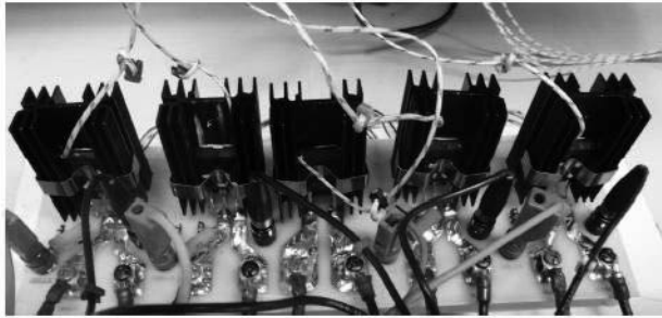
Figure 11b : Interrupteur SiC constitué de quatre transistors SJEP120R063 et d'une diode SDP30S120 testé pour un courant positif et négatif avec une résistance R_G=270\Omega et V_{CC}=30V
