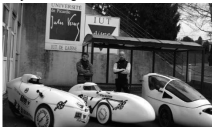
Fig. 7 : différentes réalisations de cycles électriques motorisés entièrement carénés (de 50kg à 85kg) [9, 10]
