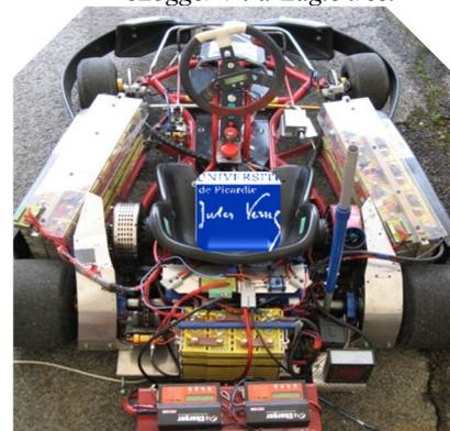
fig 10: Instrumentation lors du challenge e-Kart 2013 sur le kart électrique de l'IUT de l'Aisne et les chargeurs. 2 moteurs 800 A max, 300 A en continu sous 70 V.
