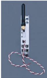
Capteur TIC (Télé Information Client) autoalimenté pour compteur électrique
