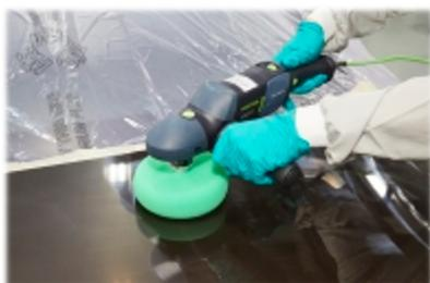
**Premièrement :** placez une mousse verte sur une lustreuse rotative et mettez-y une petite quantité de produit de traitement 3M™ Perfect-it™ Fast Cut Plus Extrême (capuchon vert). Appliquez le produit par passes croisées, à une vitesse comprise entre 600 et 1 500 Tr/min.
