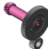
Q3.3 Calculer le rapport de transmission  $r_2$  entre le pignon conique (43) 13 dents et la roue (53) 41 dents
