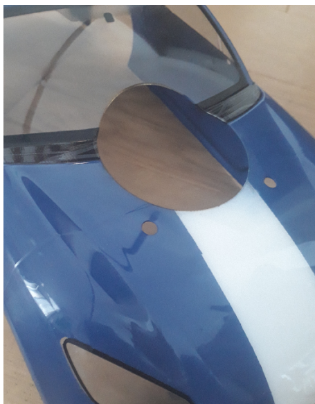
Figure 3 : Découpe du passage du lidar au laser
